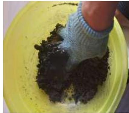
Gambar 4. Proses pencampuran bubuk arang dengan tepung tapioka
